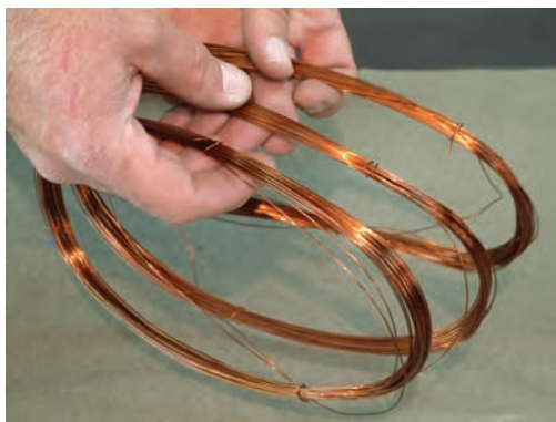
شکل ۱۹-۳ درآوردن کلاف از قالب
