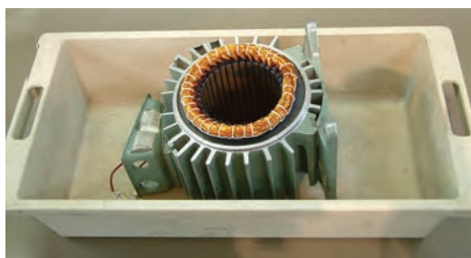
شکل ۲۱-۴- قرار دادن استاتور در درون وان شارلاک
