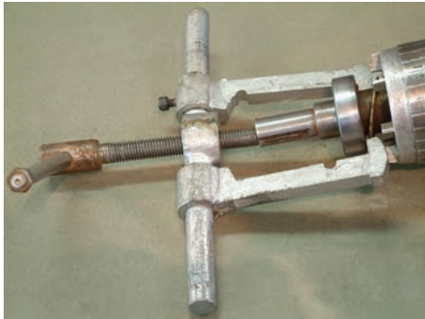
شکل ۱-۴۶- استقرار بلبرینگ کش روی محور روتور
