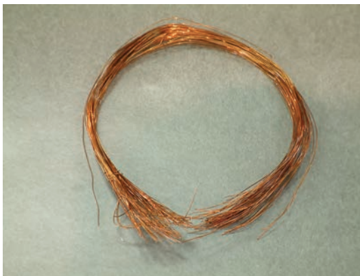
شکل ۱۶-۳- الف - شمارش تعداد دور هر بوبین
