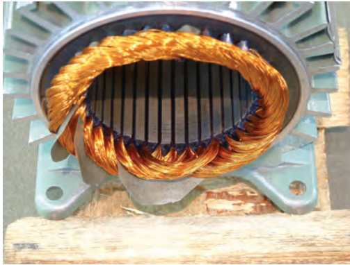
شکل ۲-۳۱- عایق کاری پیشانی کلاف‌ها
