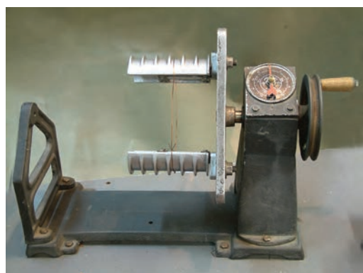
شکل ۳-۵- تنظیم قالب‌ها بر اساس اندازه‌ی کلاف
