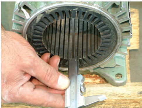
شکل ۲-۳۲- اندازه گیری طول شیار
