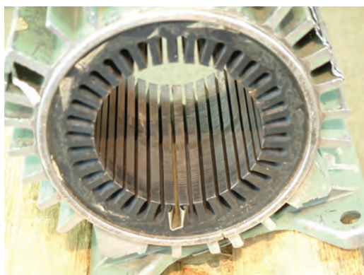
شکل ۲-۳۶- آزمایش عایق در داخل شیار
