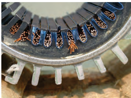
شکل ۲-۲۱ - برش سیم ها در یک طرف استاتور
