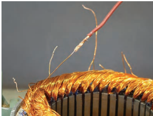
شکل ۴-۱۱- اتصال سیم‌های افشان به سیم‌های لاک‌ی
