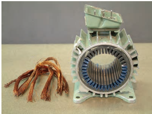
شکل ۲۴-۲- سیم‌های بیرون آمده از استاتور
