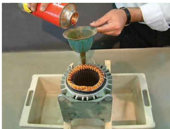
شکل ۲۵-۴- ریختن شارلاک روی سیم‌ها
