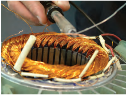
شکل ۴-۷- لحیم کاری محل اتصال سیم ها
