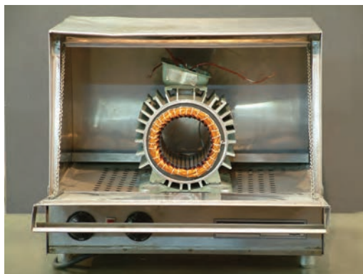
شکل ۲۰-۴- گرم کردن استاتور
