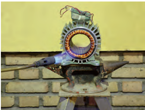
شکل ۲-۱۸- سوزاندن مستقیم سیم‌ها با شعله
