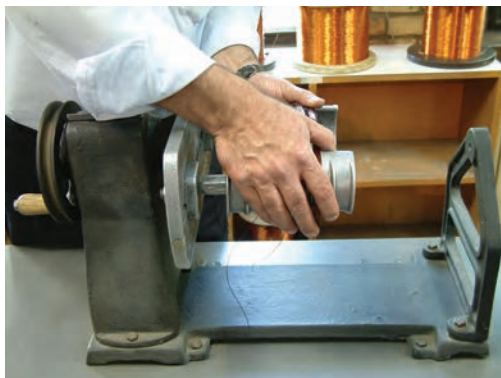
شکل ۱۸-۳ باز کردن قالب‌ها
