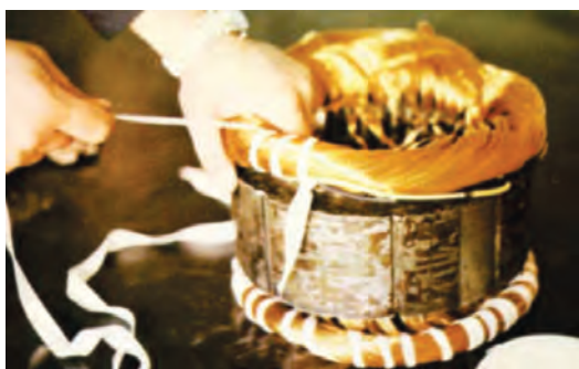
شکل ۴-۱۸– نواربندی سیم‌های استاتور
