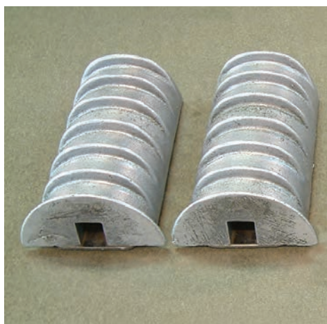
شکل ۲-۳- قالب کلاف مساوی
