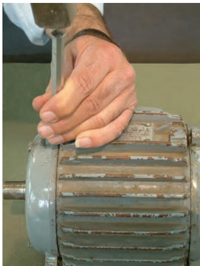
شکل ۱-۲۳- علامت‌گذاری روی پوسته و درپوش‌ها
