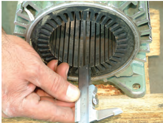
شکل ۲۶-۲- اندازه گیری محیط داخلی و طول شیار
