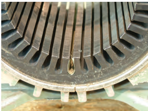
شکل ۲-۳۳- اندازه گیری محیط شیار
